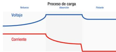
Figura 4 – Proceso de carga
