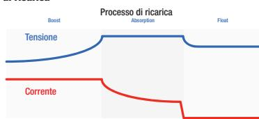
Fig. 4 – Processo di ricarica
